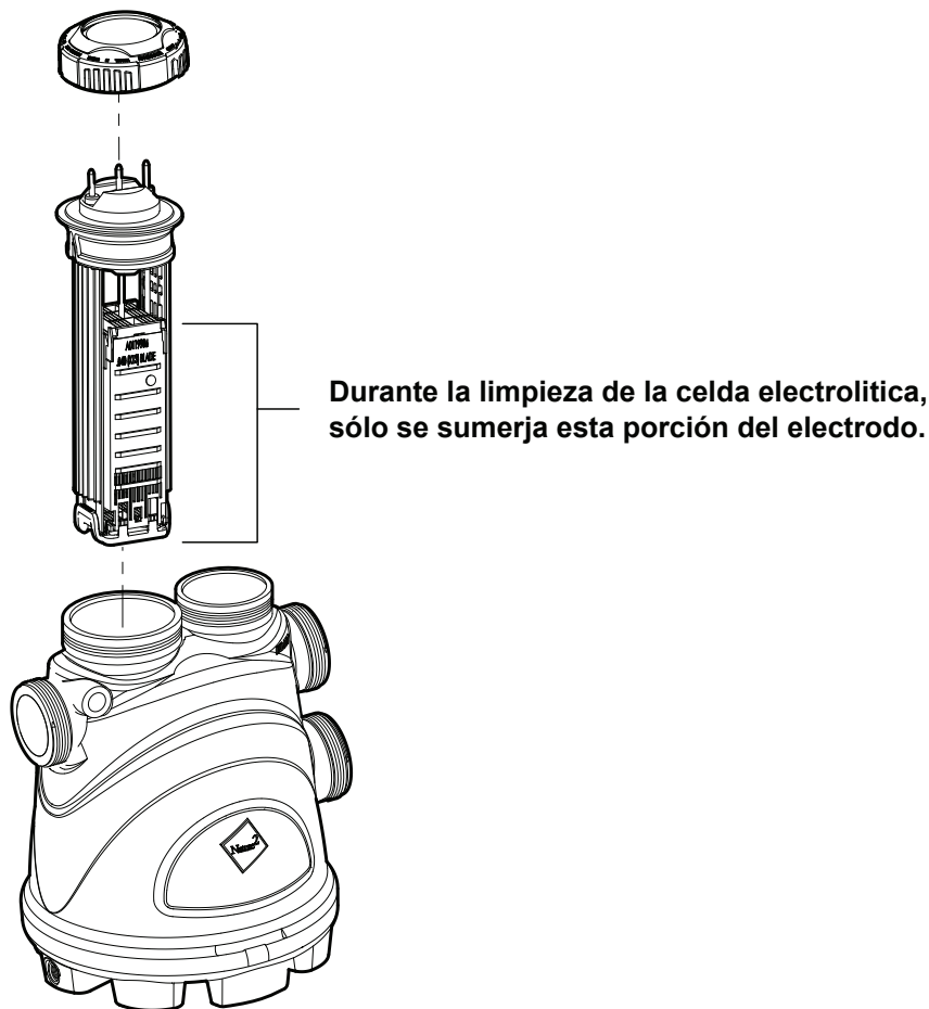
Figura 19. Limpieza de la celda electrolítica
